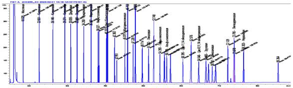
Рисунок 1. Газохроматографическое разделение 37 метиловых эфиров жирных кислот на капиллярной колонке SP-2560
